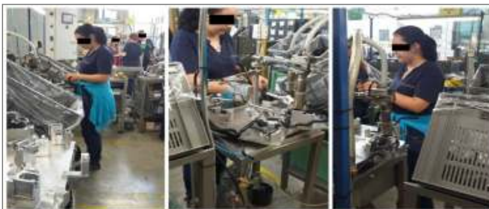
Obrázok 3 Kritické polohy tela montážneho operátora č.3 pri montáži fundy
