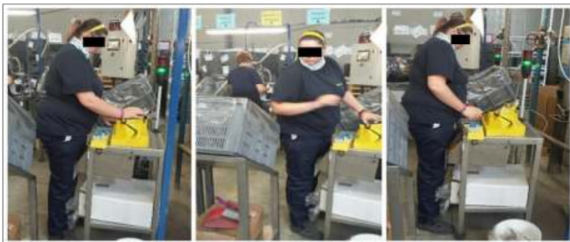
Obrázok 1 Kritické polohy tela montážneho operátora č.1 pri montáži č.2
